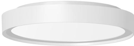
Direkt strahlende runde LED-Aufbauleuchte mit UV-beständiger Lichtverteilung. Leuchtenkörper aus Aluminiumdruckguss. Weiss pulverbeschichtet. Werkzeuglose Montag durch Federsystem. Hohe Schutzart IP54.
